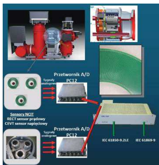
Rys. 4. Przykład prezentujący przekładnik prądowy oparty na cewce Rogowskiego (RECT) oraz przekładnik napięciowy na dzielniku pojemnościowym (CEVT) firmy GE Vernova przeznaczony do rozdzielni typu GIS
