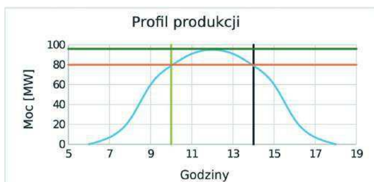
Rys. 9. Profil produkcji PV – przewymiarowanie po stronie DC
