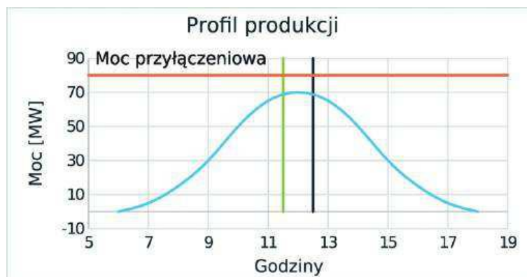
Rys. 8. Profil produkcji PV bez przewymiarowania
