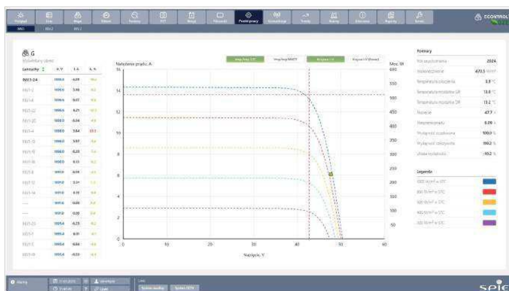
Rys. 9. System ECONTROLoze – Monitoring Punktu Pracy paneli PV
