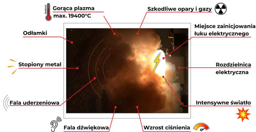
Rys. 5. Opis zjawisk powstających podczas zwarcia łukowego – opracowanie własne autora
