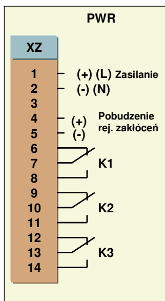
Rys. 2.6 Widok karty zasilacza typu B2 (220VDC/ 230VAC)
