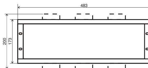
WYMIARY AUTOMATU AZR W WERSJI 11 OBUDOWA ZATABLICOWA KASETA EURO 84T (APRA)
