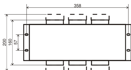
WYMIARY AUTOMATU AZR W WERSJI 5 OBUDOWA NATABLICOWA KASETA EURO 63T (APRA)
