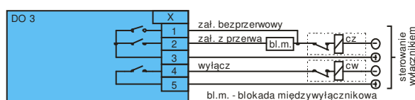
Rys. 31. Przykładowy schemat sterowania wyłącznikiem.
