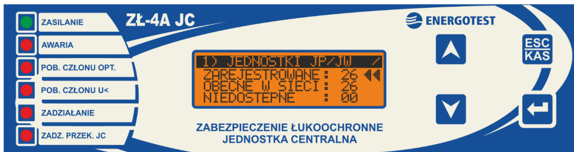
rys. 2 Płyta czołowa jednostki centralnej ZŁ-4A JC.
