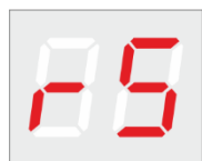
rys. 29 Adres sieciowy skonfigurowanej jednostki wyłączającej.
