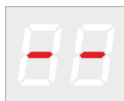
rys. 19 Komunikat na wyświetlaczu jednostki polowej bez adresu sieciowego.
