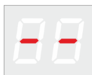
rys. 28 Komunikat na wyświetlaczu jednostki wyłączającej bez adresu sieciowego.
