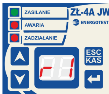
rys. 4 Płyta czołowa jednostki wyłączającej ZŁ-4A JW.
