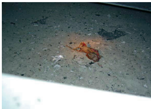
Rys. 10. Plamy stopionego aluminium, oraz spalone szczątki gryzonia, który wywołał zwarcie
